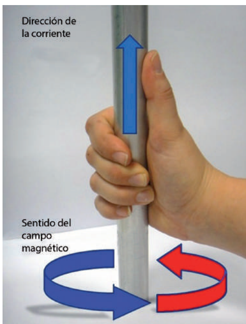
Determinación de la dirección del campo magnético por medio de la regla de la mano derecha.
