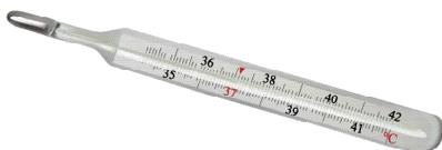
Los instrumentos que miden la temperatura de un cuerpo o sustancia se denominan termómetros. Existe una variedad de termómetro; pero el más usado es el termómetro clásico, que posee un bulbo metálico que contiene mercurio, que estabiliza y mantiene el registro de la temperatura por un buen tiempo.
