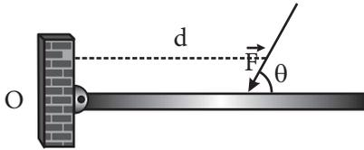
En este caso, lo primero que se tiene que realizar es la descomposición de la fuerza aplicada en dos componentes: una componente perpendicular a la barra, y una paralela a la barra.
