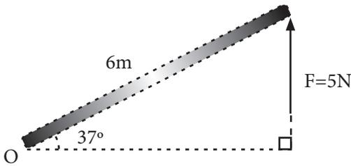
8. Determina el módulo del momento resultante (en N.m) sobre la barra inerte con respecto al punto O.
