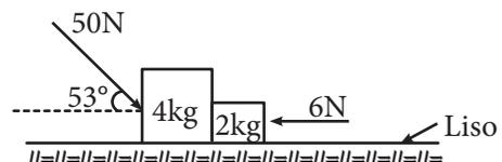
8. Calcula el módulo de la fuerza F si los bloques experimentan una aceleración de  $5 \text{ m/s}^2$ .
