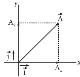
Componentes de un vector en una dirección determinada. Por consiguiente, tenemos:
