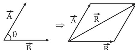
Este caso se trazan las paralelas a los vectores por sus extremos. La unión del origen de los vectores con la intersección de las paralelas es el vector resultante.
